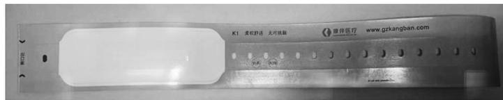
图2 杜邦纸RFID电子标签腕带实物图
